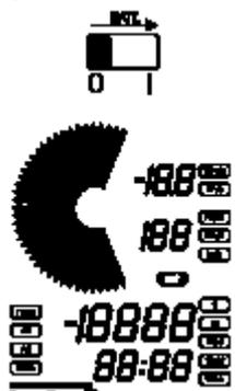
начинается автоматический самоконтроль. На секунду на дисплее одновременно отображаются все элементы.
