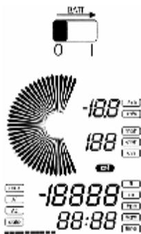
запускается автоматическое тестирование прибора. На короткое время появляются все элементы дисплея.
